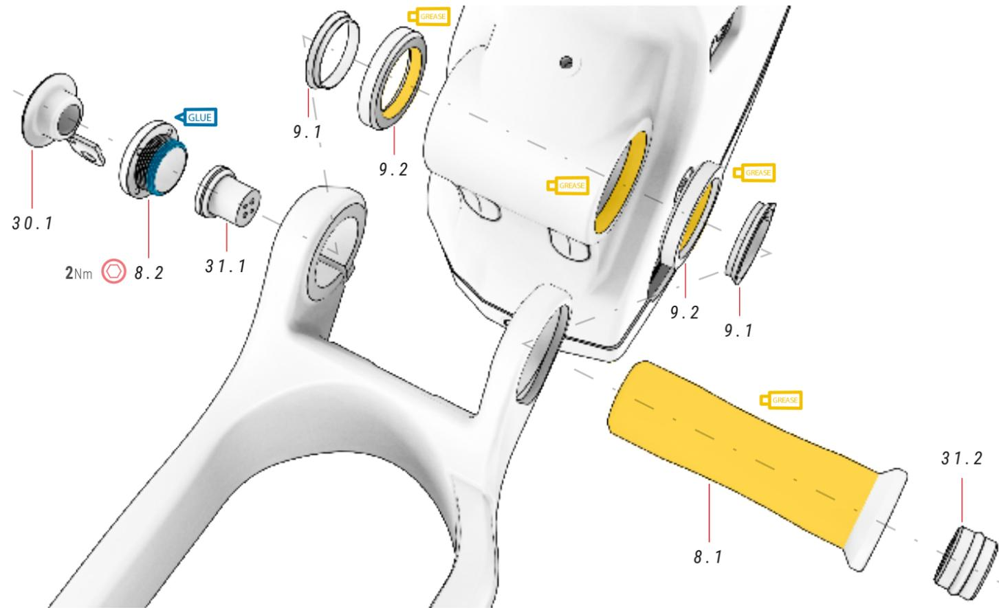
ⓘ Das Teil 8.2 darf nicht mit mehr als 2 Nm angezogen werden, da seine Funktion darin liegt, Spiel zu vermeiden. Die Schraube 10.2 befestigt vollständig das Teil 8.2 und den Rest der Schwingenbaugruppe.
