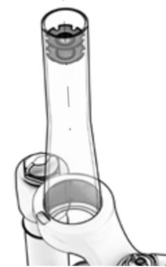
**⚠** Es empfiehlt sich, einen Stumpfer zu verwenden, um sicherzustellen, dass der Spider perfekt ausgerichtet in das Steuerrohr eingesetzt wird.
