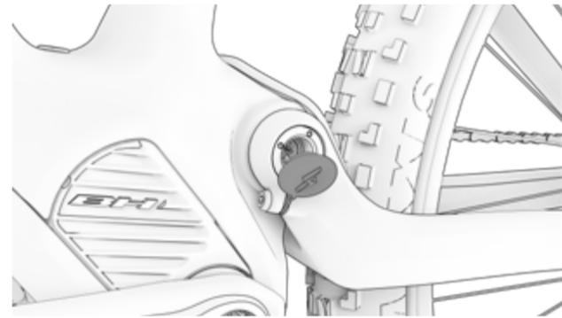
5. TRENNEN SIE IMMER ZUERST DAS LADEGERÄT VON DER BATTERIE UND DANACH VOM NETZSTROM.
