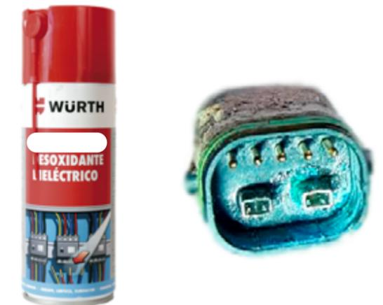
⚠ Wenn ein elektrischer Anschluss feucht wird oder durch eine äußere Verschmutzung verdichtet ist, kommt es zu einer chemischen Reaktion, durch die die Verbindungen sulfatisiert werden. Das heißt, das Kupfer der Kontakte oxidiert und es kommt zu Störungen bei der Leitfähigkeit.
