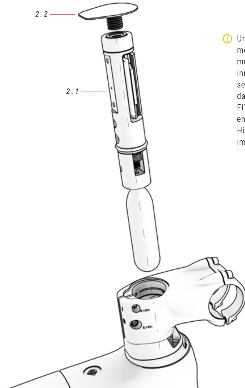
ⓘ Um das FIT-Tool montieren zu können, muss der Steuersatz innen vollständig leer sein. Benutzen Sie das dafür vorgesehene FIT-Waschsystem und entfernen Sie eventuelle Hindernisse wie den Spider im Steuerrohr.
