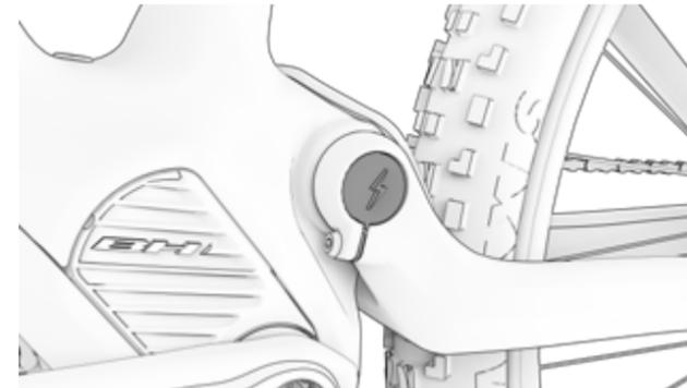
7. DIE XPRO-BATTERIE WIRD GELADEN, WENN SIE SICH IM FLASCHENHALTER BEFINDET UND DAS FAHRRAD BEI EINGESCHALTETER, I-REMOTE GELADEN WIRD.
