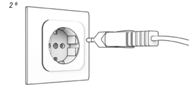
3. SCHLIESSEN SIE IMMER ZUERST DAS LADEGERÄT AN DIE BATTERIE AN UND DANACH AN DEN NETZSTROM.
