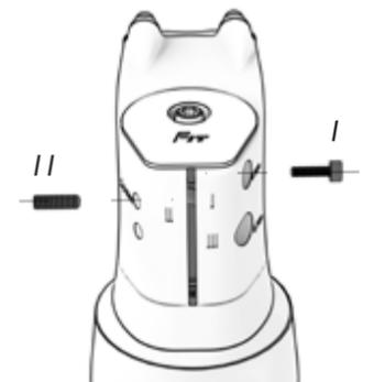
**⚠** Der Zweck des Festziehens der Schrauben besteht darin, die Unterlegscheiben am Verschieben zu hindern. Wenden Sie daher nicht zu viel Drehmoment an.
