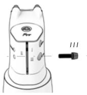
Der Vorbau muss perfekt auf das Rad ausgerichtet sein. 2. SETZEN SIE DIE GABEL IN DEN GABELSCHAFT EIN UND ZIEHEN SIE DIE OBERE SCHRAUBE (5 NM) AN, UM DAS SPIEL ZU BESEITIGEN.
