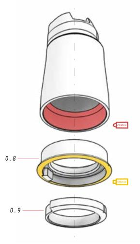
① Das Teil 0.8 kann mit der zum Rahmen zeigenden Kerbe montiert werden, aber das Teil 0.9 muss immer im Verhältnis zur Position der ersten montiert werden, wie in den Abbildungen dargestellt.
