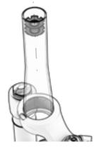
Um sicherzustellen, dass der Spider perfekt ausgerichtet in den Gabelschaft eingesetzt wird, empfiehlt sich die Verwendung eines Stumpfers.
