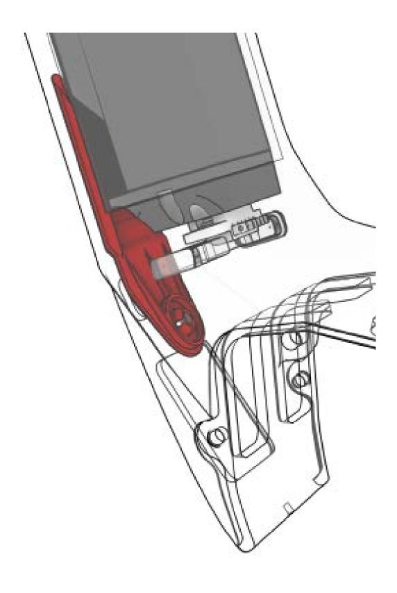
**ZUSAMMENBAU:** ENTFERNEN SIE DIE PLASTIKFOLIE, DIE DEN KLEBER VOM TEIL SCHÜTZT. SETZEN SIE ES DANN IN DAS DIAGONALROHR DES FAHRRADS EIN UND MONTIEREN SIE ES, INDEM SIE ES GEGEN DAS GEHÄUSE DER SCHRAUBE (ROT MARKIERT) DRÜCKEN, MIT DER DIE MOTORABDECKUNG BEFESTIGT IST. ZUM SCHLUSS DRÜCKEN SIE DAS TEIL GEGEN DEN RAHMEN, SODASS DER KLEBER ES VOLLSTÄNDIG FIXIERT.
