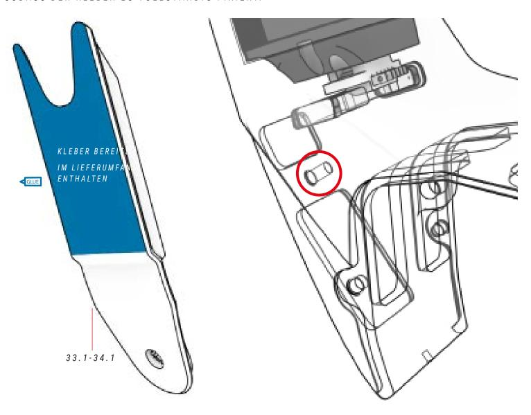
① Überprüfen Sie, ob die Rahmengröße in die kompatible Batterieführung passt. Montieren Sie es in der gleichen Größe wie der Rahmen.
