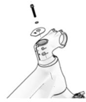
↑ Die Unterlegscheiben haben beim Einbau des Spiders keine Funktion mehr. Daher können Sie sie entweder entfernen oder im Stiel aufbewahren.
