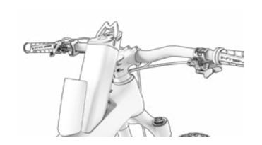
4. SCHLIESSEN SIE DIE RAHMENABDECKUNG, UM SICHERZUSTELLEN, DASS KEIN SCHMUTZ EINDRINGT, WENN DER AKKU ZUM LADEN AUSSERHALB DES FAHRRADS ENTFERNT WURDE.
