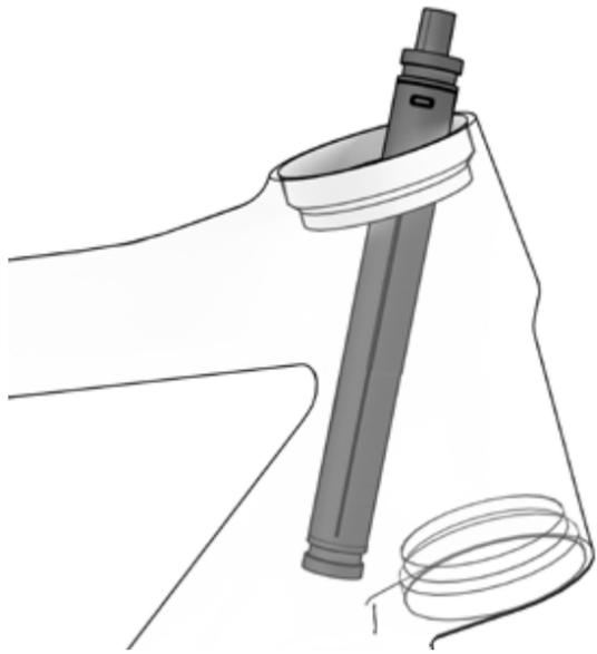
2. ZIEHEN SIE DAS ENDE DER BATTERIE AUS DER ÖFFNUNG IM TRETLAGERGEHÄUSE.
