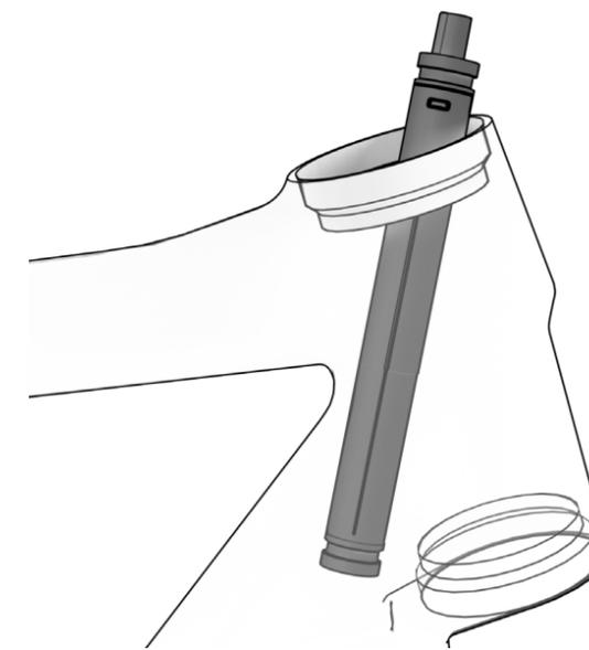
2. ZIEHEN SIE DAS ENDE DER BATTERIE AUS DEM LOCH IM TRETLAGERGEHÄUSE HERAUS.
