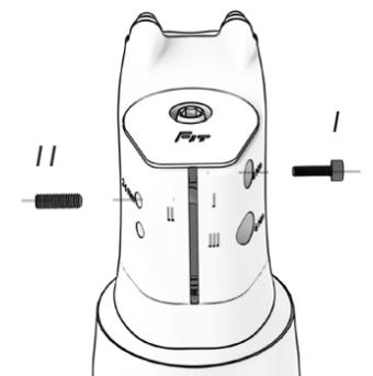
**⚠** Le serrage des boulons a pour but d'empêcher les rondelles de bouger. Il ne faut donc pas appliquer un couple trop important.
