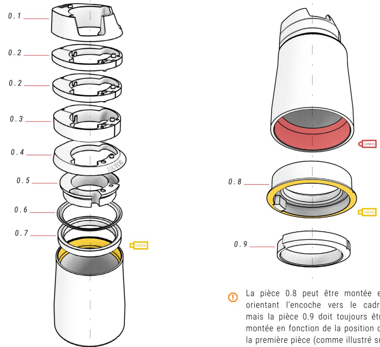
⚠ La pièce 0.8 peut être montée en orientant l'encoche vers le cadre, mais la pièce 0.9 doit toujours être montée en fonction de la position de la première pièce (comme illustré sur les images).
