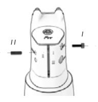
⚠ Le serrage des boulons a pour but d'empêcher les rondelles de bouger. Il ne faut donc pas appliquer un couple trop important.
