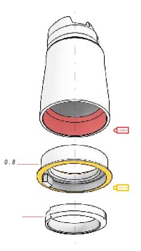
Da pièce 0.8 peut être montée en orientant l'encoche vers le cadre, mais la pièce 0.9 doit toujours être montée en fonction de la position de la première pièce (comme illustré sur les images).
