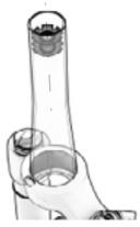
Il est conseillé d'utiliser un émoussoir pour s'assurer que l'araignée est insérée dans le tube de direction de manière parfaitement alignée.
