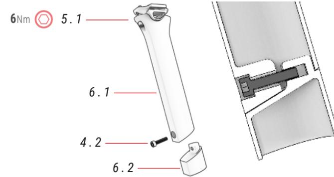
⚠ La vis 4.2 doit se trouver à l'intérieur de la tige de selle et les pièces 6.1 et 6.2 doivent être alignées.
