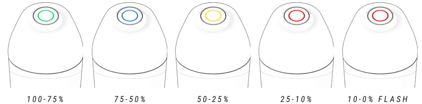
Sur les modèles équipés de l'afficheur Core Display, le niveau de charge de la batterie XPRO est indiqué par l'intermédiaire de l'anneau de voyants. La capacité de la batterie XPRO est ajoutée à la capacité de la batterie interne du vélo et l'écran affiche la charge totale de l'ensemble comme suit :
