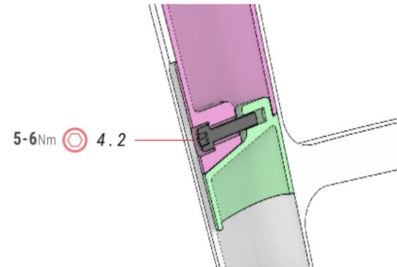
⚠ Respectez toujours les hauteurs maximales et minimales indiquées pour garantir le bon fonctionnement du système de serrage intégré de la tige de selle. Les dommages résultant d'un réglage incorrect ne seront pas couverts par la garantie et pourraient entraîner des accidents graves.
