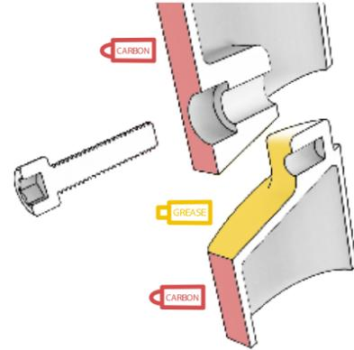
3. INSÉREZ LA TIGE DE SELLE DANS LE CADRE À LA HAUTEUR SOUHAITÉE ET SERREZ LA VIS.
