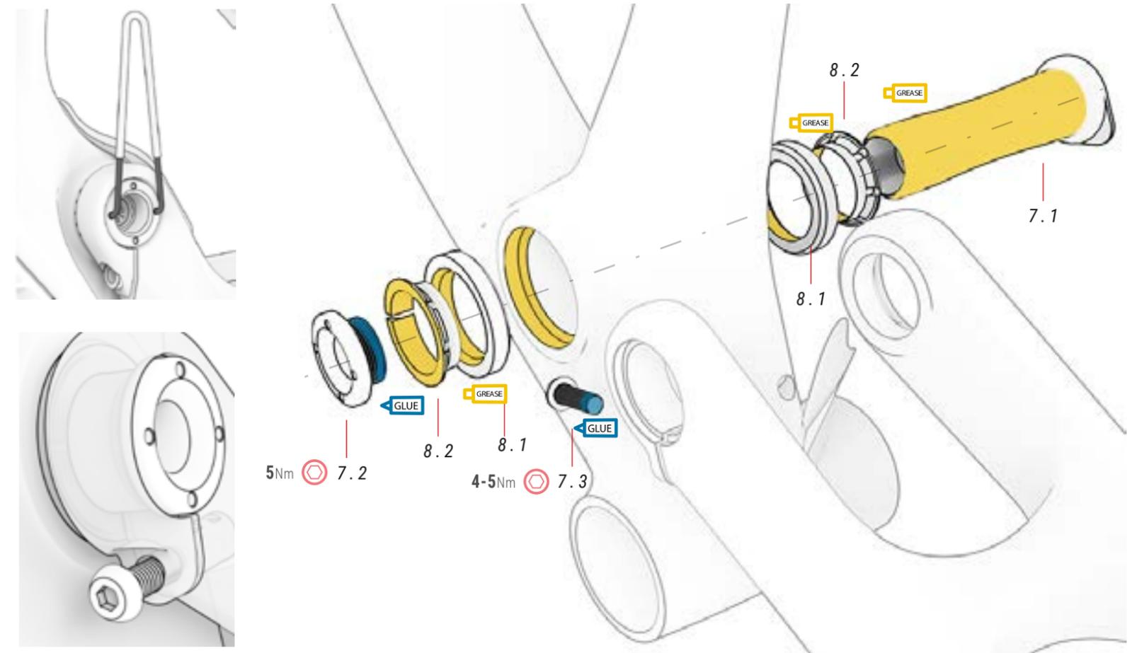
⚠ Desserrez toujours la vis 7.3 avant de monter ou de démonter la pièce 7.2. La pièce 7.2 est conçue pour être filetée avec une goupille de clé 2,4 mm de diamètre
