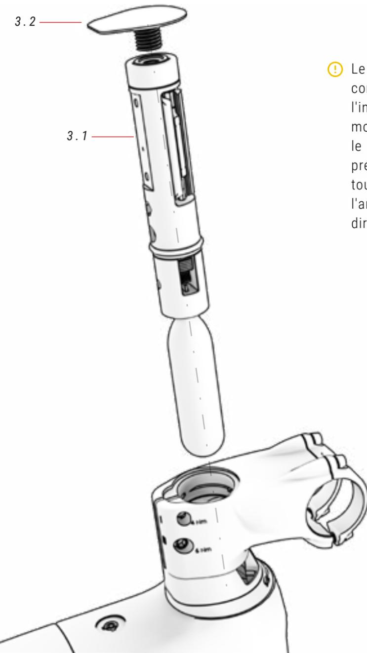
⚠ Le casque doit être complètement vide à l'intérieur pour pouvoir monter l'outil FIT. Utilisez le système de rondelle FIT prévu à cet effet et retirez tous les obstacles tels que l'araignée dans le tube de direction.
