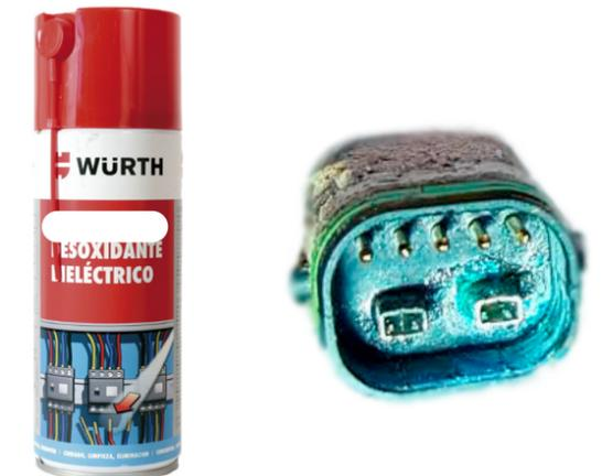
⚠ Lorsqu'un branchement électrique entre en contact avec de l'humidité ou qu'il se retrouve bouché en raison d'un agent polluant extérieur, une réaction chimique se produit et les raccordements sont soumis à un phénomène de sulfatation. Le cuivre des contacts s'oxyde et provoque des problèmes de conductivité.
