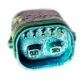
Lorsqu'un branchement électrique entre en contact avec de l'humidité ou qu'il se retrouve bouché en raison d'un agent polluant extérieur, une réaction chimique se produit et les raccordements sont soumis à un phénomène de sulfatation Le cuivre des contacts s'oxyde et provoque des problèmes de conductivité.
