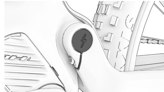
7. LA BATTERIE XPRO SE RECHARGE SI ELLE SE TROUVE DANS LE PORTE-BIDON, SI LE VÉLO EST EN COURS DE RECHARGE ET SI L'I-REMOTE EST ALLUMÉ.
