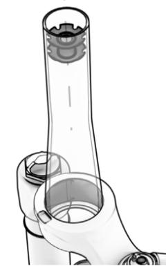
**⚠** Il est conseillé d'utiliser un émoussoir pour s'assurer que l'araignée est insérée dans le tube de direction de manière parfaitement alignée.
