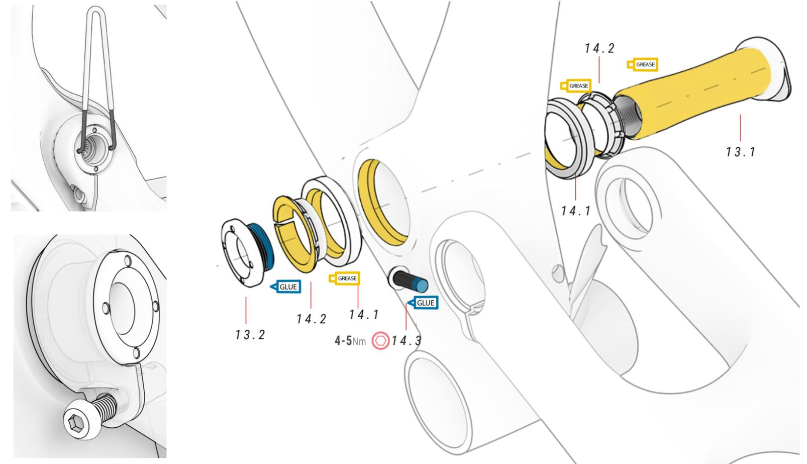
⚠ Desserrez toujours la vis 13.3 avant de monter ou de démonter la pièce 13.2. La pièce 13.2 est conçue pour être filetée avec une goupille de clé 2,4 mm de diamètre
