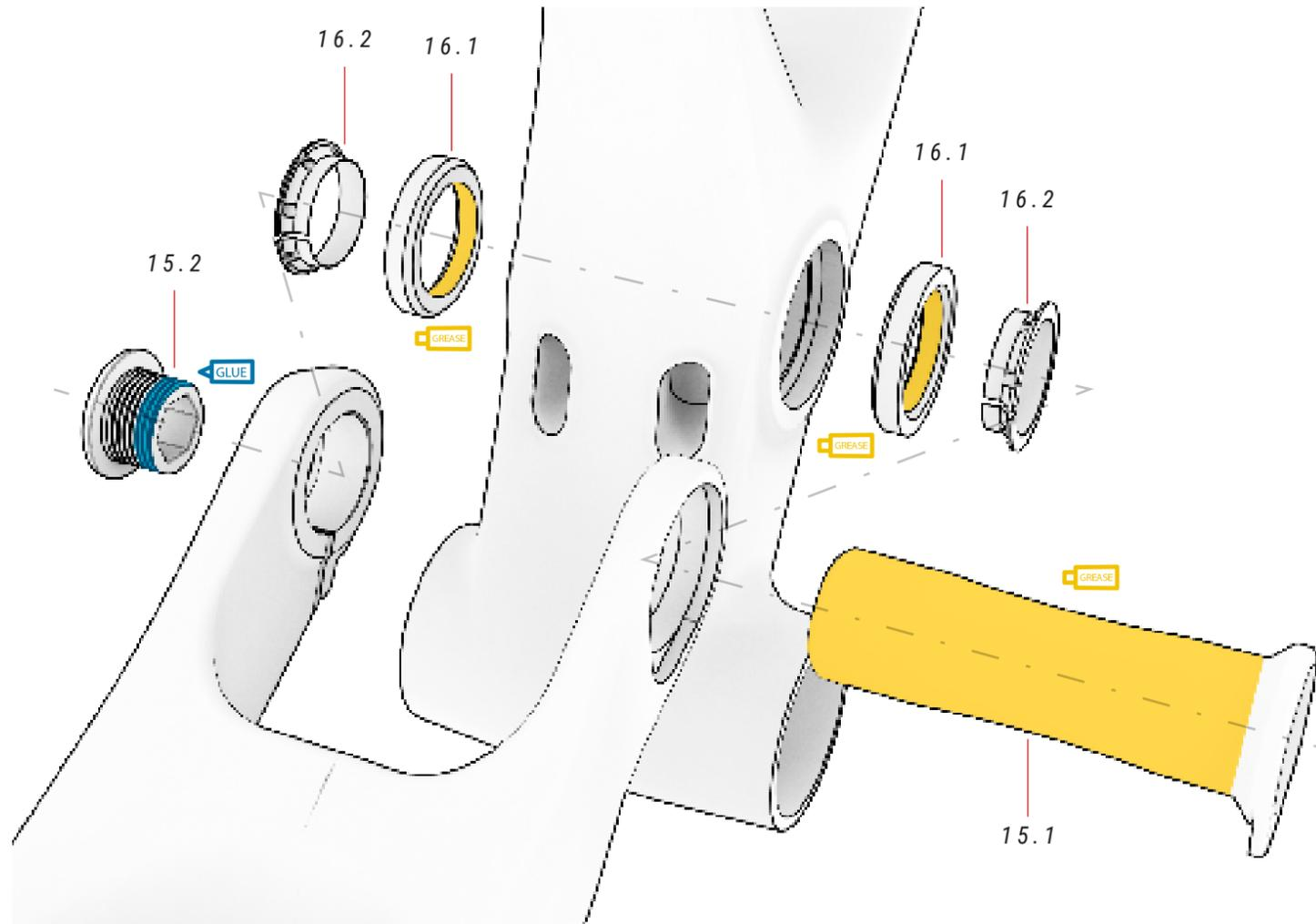
⚠ La pièce 15.2 ne doit pas serrer à plus de 4 Nm puisque sa fonction est d'éviter le jeu. La partie 18.1/17.1 corrigera complètement la partie 15.2.
