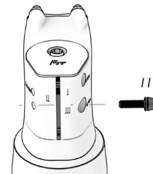
**⚠** La potence doit être parfaitement alignée avec la roue.
