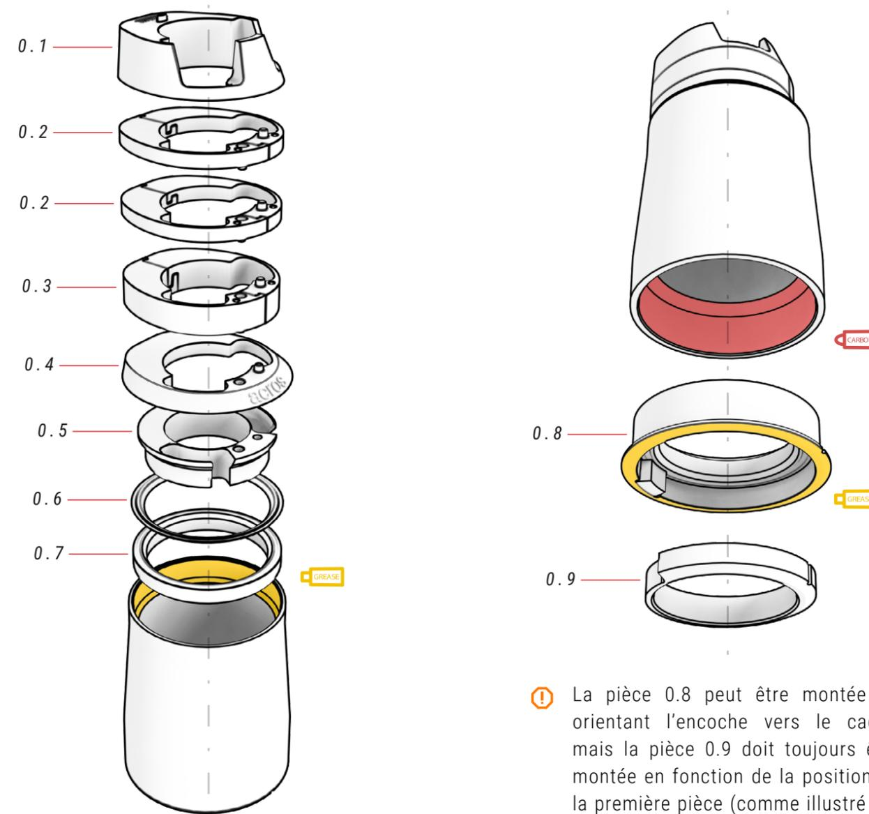
⚠ La pièce 0.8 peut être montée en orientant l'encoche vers le cadre, mais la pièce 0.9 doit toujours être montée en fonction de la position de la première pièce (comme illustré sur les images).
