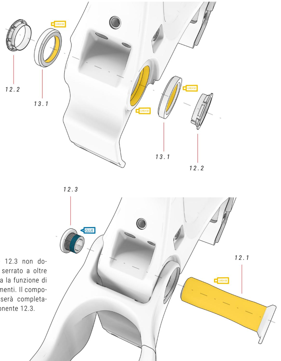
⚠ Il componente 12.3 non dovrebbe essere serrato a oltre 2 Nm poiché ha la funzione di evitare allentamenti. Il componente 11.3 fisserà completamente il componente 12.3.
