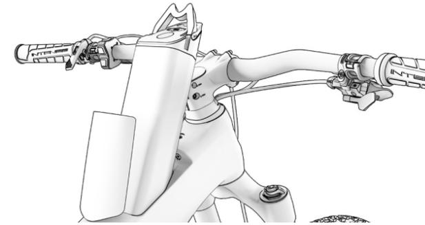
11. ABBASSARE L'IMPUGNATURA DELLA BATTERIA PRIMA DI CHIUDERE IL COPERCHIO DEL TELAIO.
