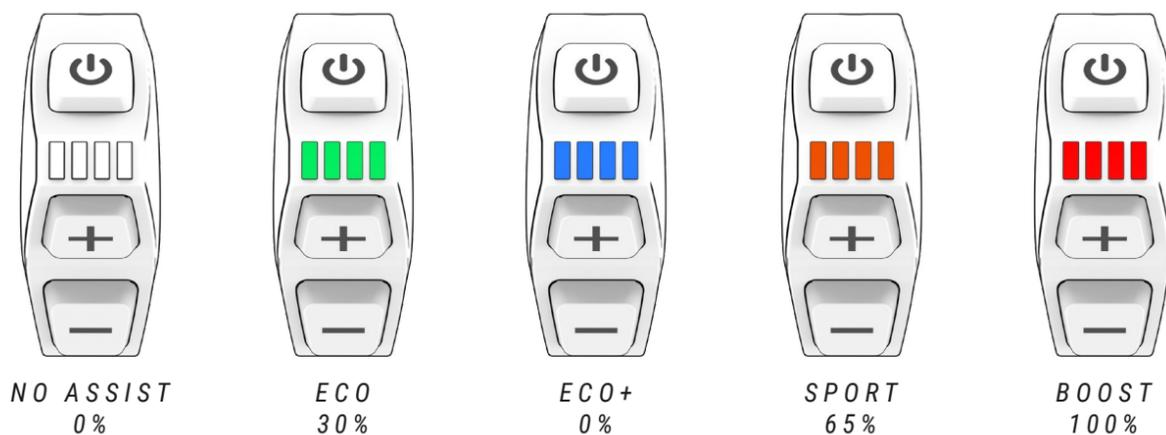
Per aumentare la vita utile della batteria e impedire uno scaricamento completo che potrebbe danneggiarla, le modalità di pedalata assistita possono essere limitate in funzione del livello di carica della batteria:
