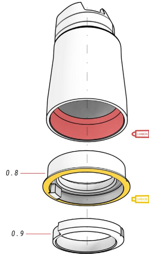
ⓘ Il componente 0.8 si può montare con la tacca rivolta al telaio, ma il componente 0.9 deve essere sempre montato in base alla posizione del primo, come mostrato nelle figure.
