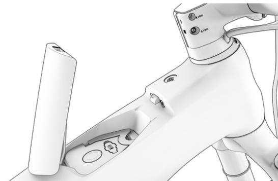
10. INSERIRE LA BATTERIA NEL TELAIO.
