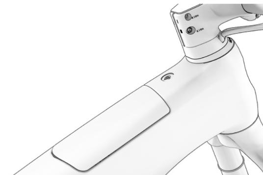
5. **APRIRE IL COPERCHIO DELLA BATTERIA PER COLLEGARE IL CARICABATTERIA PRIMA ALLA BATTERIA E POI ALLA PRESA DI CORRENTE.**
