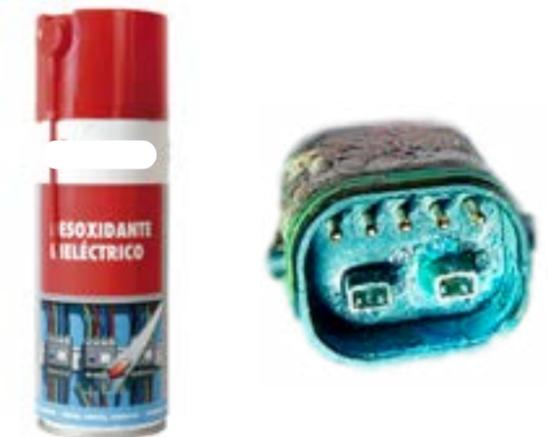
**⚠** Quando un collegamento elettrico entra in contatto con umidità o viene ostruito a causa di una contaminazione esterna, si verifica una reazione chimica che determina la solfatazione dei collegamenti. Ciò significa che il rame dei contatti si ossida, causando difetti di conducibilità.
