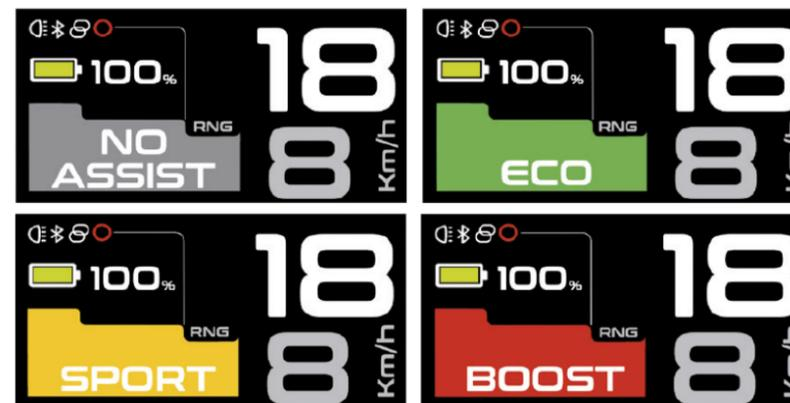
Per aumentare la vita utile della batteria e impedire uno scaricamento completo che potrebbe danneggiarla, le modalità di pedalata assistita possono essere limitate in funzione del livello di carica della batteria:
