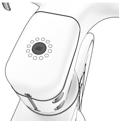
**2. APRIRE IL COPERCHIO DELLA PORTA DI RICARICA SUL LATO INFERIORE SINISTRO DEL TELAIO.**
