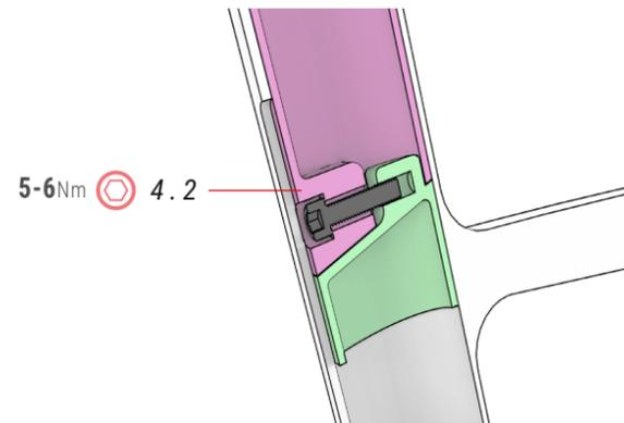
⚠ Rispettare sempre le altezze massime e minime specificate per garantire che il sistema di bloccaggio integrato del reggisella funzioni correttamente. I danni derivanti da una regolazione errata non saranno coperti dalla garanzia e potrebbero causare gravi incidenti.
