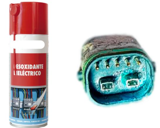
⚠ Quando un collegamento elettrico entra in contatto con umidità o viene ostruito a causa di una contaminazione esterna, si verifica una reazione chimica che determina la solfatazione dei collegamenti. Ciò significa che il rame dei contatti si ossida, causando difetti di conducibilità.
