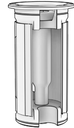
⚠ Le forcelle in carbonio non devono mai essere montate con perno. Il perno potrebbe forzare la forcella con una pressione per la quale non è stato progettato. Potrebbe rompersi e provocare un incidente.
