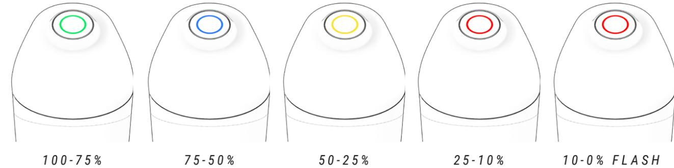
Nei modelli dotati di display Core, il livello di carica della batteria XPRO verrà visualizzato tramite l'anello di LED. La capacità della batteria dell'XPRO verrà aggiunta alla capacità della batteria interna della bicicletta e il display mostrerà la carica totale di entrambe le batterie come segue:
