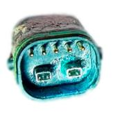
Quando un collegamento elettrico entra in contatto con umidità o viene ostruito a causa di una contaminazione esterna, si verifica una reazione chimica che determina la solfatazione dei collegamenti. Ciò significa che il rame dei contatti si ossida, causando difetti di conducibilità.
