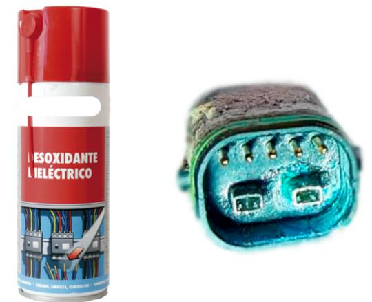
**⚠** Quando i collegamenti elettrici entrano in contatto con punti umidi o vengono ostruiti a causa di una contaminazione esterna, si verifica una reazione chimica che causa un accumulo di cristalli di solfato di piombo nei collegamenti. In altre parole, il rame sui contatti si arrugginirà, causando problemi di conduttività.
