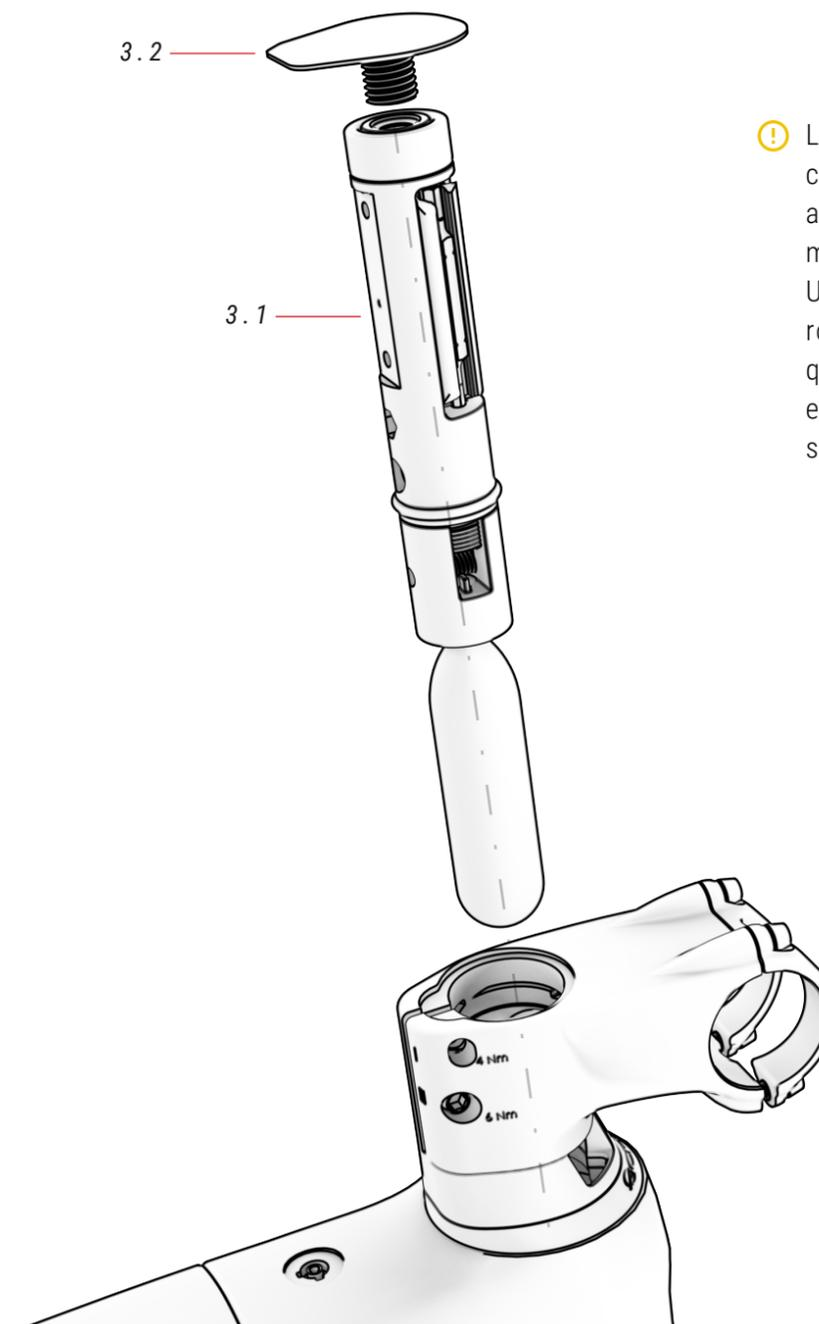
⚠ L'auricolare deve essere completamente vuoto all'interno prima di poter montare lo strumento FIT. Utilizzare il sistema di rondelle FIT progettato per questo scopo e rimuovere eventuali ostacoli come lo spider sul tubo sterzo.
