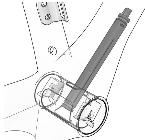
4. INSERIRE LE PARTI IN PLASTICA NEL FORO FINO A FISSARE IL TUTTO.
