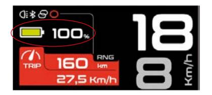
A autonomia do sistema varia em função das seguintes condições de condução, entre outros fatores: arranques e paragens frequentes, desenvolvimento da transmissão, muitas inclinações acentuadas, mau estado da estrada, transporte de cargas pesadas, vento forte de frente, baixa temperatura ambiente, deterioração da bateria, utilização da iluminação integrada, regulação incorreta da pressão dos pneus, corrente ou travões.
