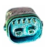
Quando uma ligação elétrica entra em contacto com humidade ou está alterada devido a uma contaminação externa, ocorre uma reação química pela qual as ligações ficam sulfatadas. Isto é, o cobre dos contactos oxida-se, provocando falhas de condutividade.
