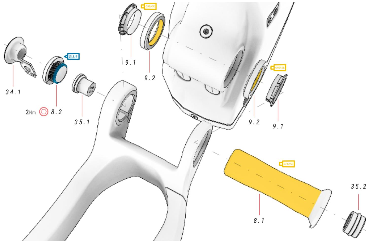
⚠ A peça 8.2 não deve apertar-se mais de 2 Nm, pois a sua função é evitar folgas. O parafuso 10.2 fixa completamente a peça 8.2 e o resto do conjunto do braço oscilante.
