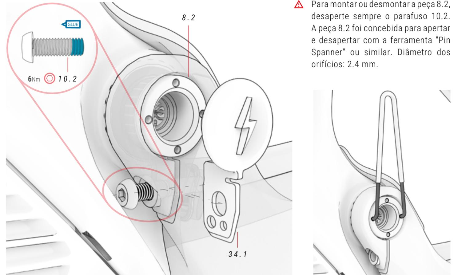
⚠ Para montar ou desmontar a peça 8.2, desaperte sempre o parafuso 10.2. A peça 8.2 foi concebida para apertar e desapertar com a ferramenta "Pin Spanner" ou similar. Diâmetro dos orifícios: 2.4 mm.
