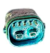
Quando uma ligação elétrica entra em contacto com humidade ou está alterada devido a uma contaminação externa, ocorre uma reação química pela qual as ligações ficam sulfatadas. Isto é, o cobre dos contactos oxida-se, provocando falhas de condutividade.
