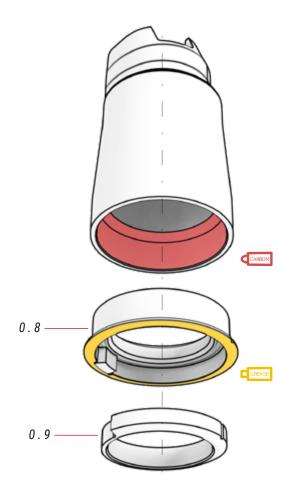
① A peça 0.8 pode ser montada com o entalhe virado para o quadro, mas a peça 0.9 deve sempre ser montada de acordo com a posição da primeira, como indicado nas imagens.
