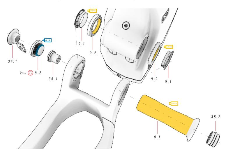
① A peça 8.2 não deve apertar-se mais de 2 Nm, pois a sua função é evitar folgas. O parafuso 10.2 fixa completamente a peça 8.2 e o resto do conjunto do braço oscilante.
