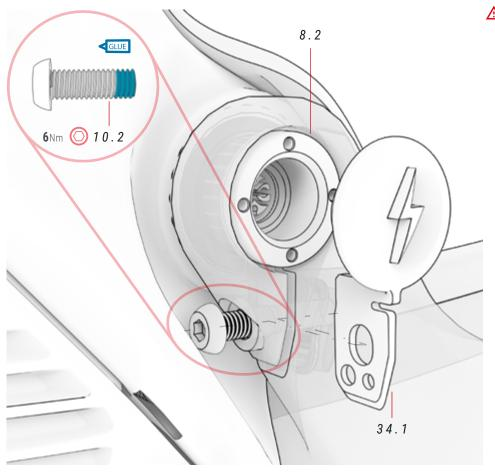
♠ Para montar ou desmontar a peça 8.2, desaperte sempre o parafuso 10.2. A peça 8.2 foi concebida para apertar e desapertar com a ferramenta "Pin Spanner" ou similar. Diâmetro dos orifícios: 2.4 mm.
