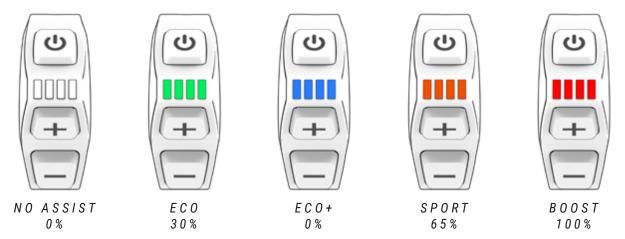
Para aumentar a vida da bateria e evitar que a mesma se descarregue totalmente, o que poderia danificá-la, os modos de assistência estão limitados em função da carga da bateria:
