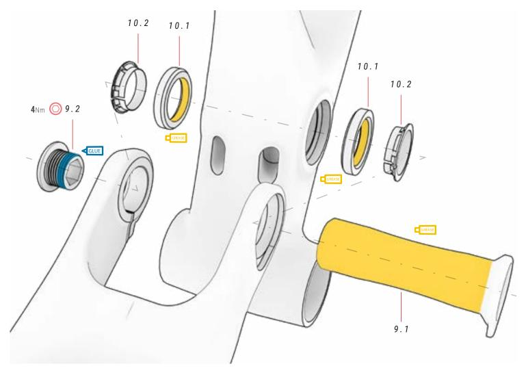
A peça 9.2 não deve apertar-se mais de 4 Nm, pois a sua função é evitar folgas. A peça 11.1 fixa completamente a peça 9.2.
