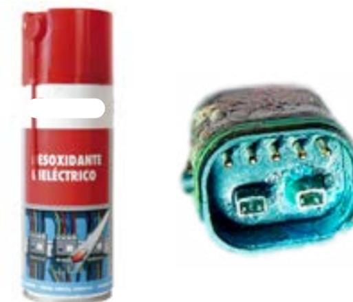
⚠ Quando uma ligação elétrica entra em contacto com humidade ou está alterada devido a uma contaminação externa, ocorre uma reação química pela qual as ligações ficam sulfatadas. Isto é, o cobre dos contactos oxida-se, provocando falhas de condutividade.
