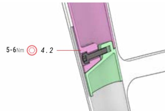
⚠ Observe sempre as alturas máximas e mínimas especificadas para garantir que o sistema integrado de fixação do espigão funciona corretamente. Danos resultantes de ajustes incorretos não serão cobertos pela garantia e poderão causar acidentes graves.
