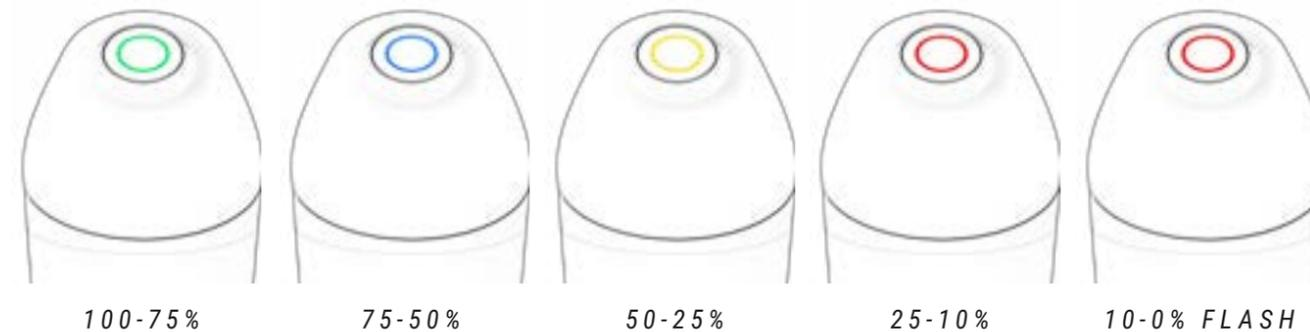
Nos modelos equipados com display Core, o nível de carga da bateria XPRO será mostrado com o anel de LEDs. A capacidade da bateria XPRO será somada à capacidade da bateria interna da bicicleta e o display mostrará a carga total de ambas as baterias da seguinte forma:
