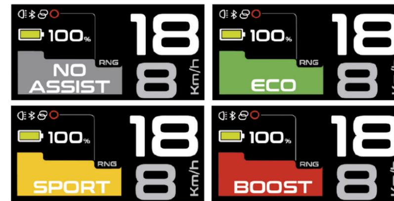
Para aumentar a vida da bateria e evitar que a mesma se descarregue totalmente, o que poderia danificá-la, os modos de assistência estão limitados em função da carga da bateria:
