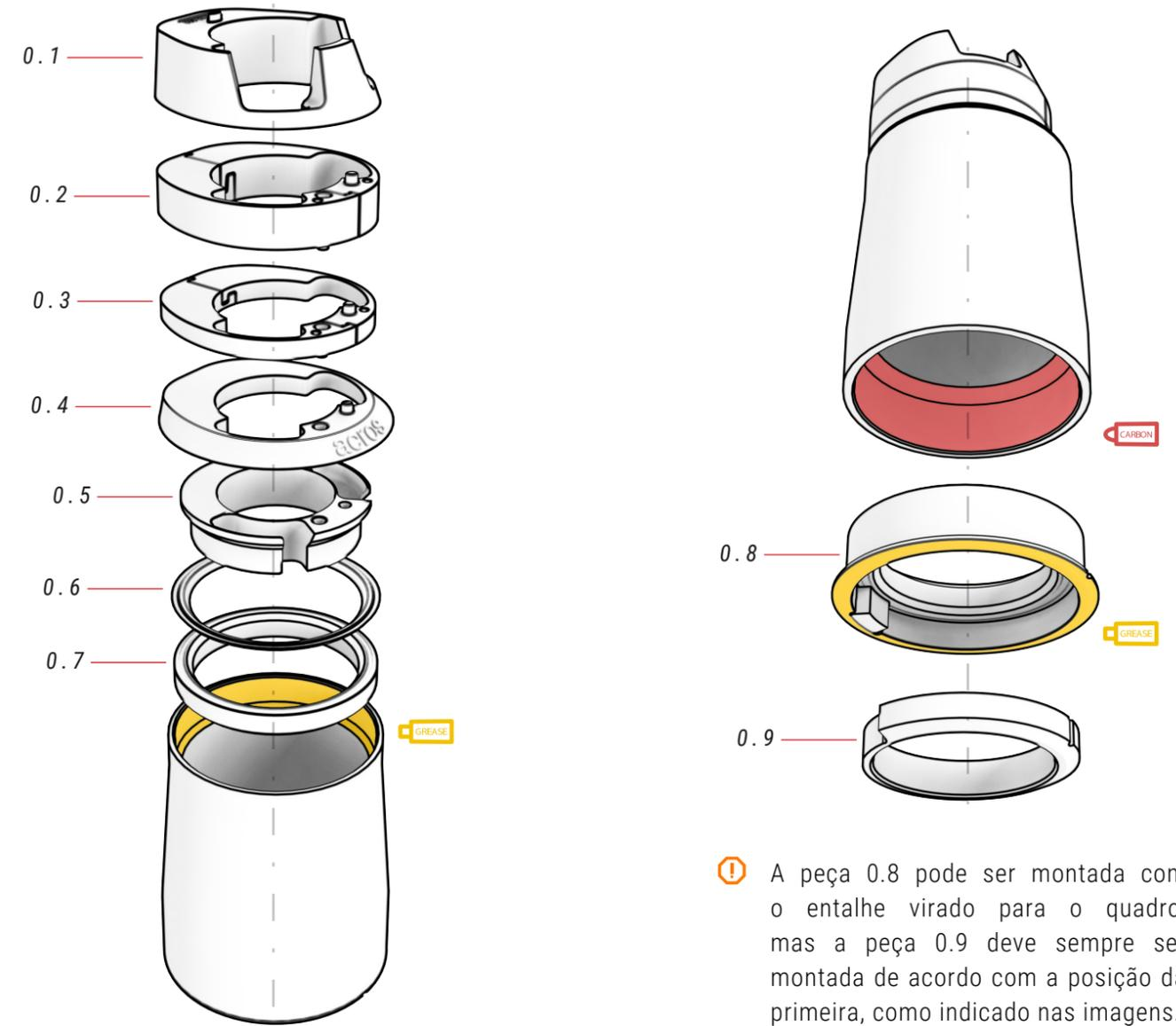
⚠ A peça 0.8 pode ser montada com o entalhe virado para o quadro, mas a peça 0.9 deve sempre ser montada de acordo com a posição da primeira, como indicado nas imagens.
