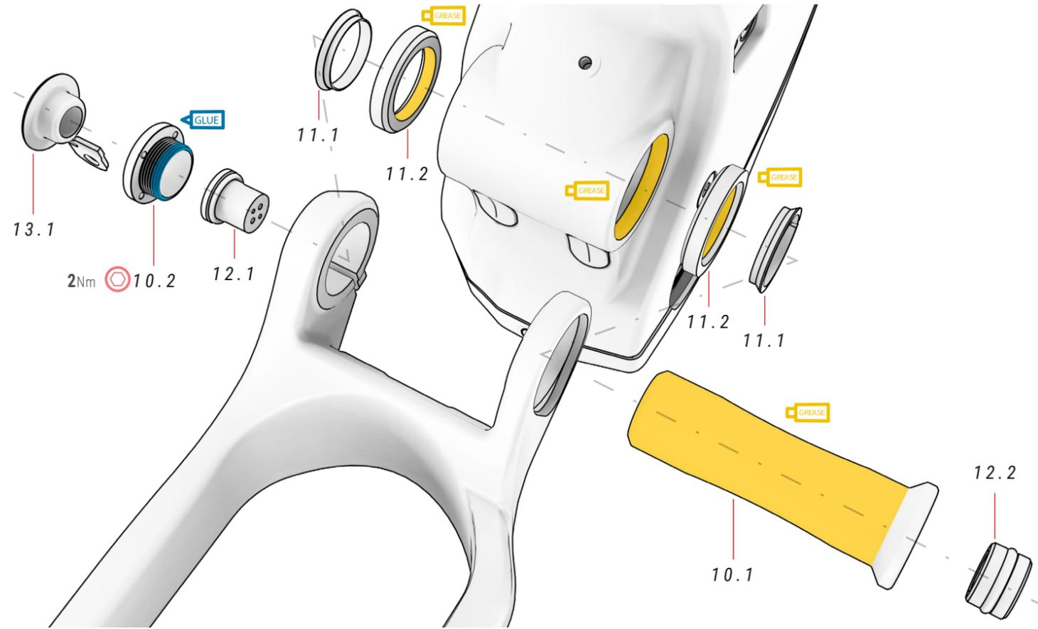
ⓘ A peça 10.2 não deve apertar-se mais de 2 Nm, pois a sua função é evitar folgas. O parafuso 12.2 fixa completamente a peça 10.2 e o resto do conjunto do braço oscilante.
