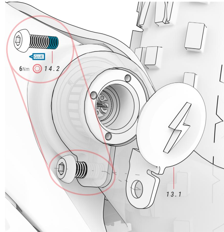
⚠ Para montar ou desmontar a peça 10.2, desaperte sempre o parafuso 14.2. A peça 10.2 foi concebida para apertar e desapertar com a ferramenta "Pin Spanner" ou similar. Diâmetro dos orifícios: 2.4 mm.
