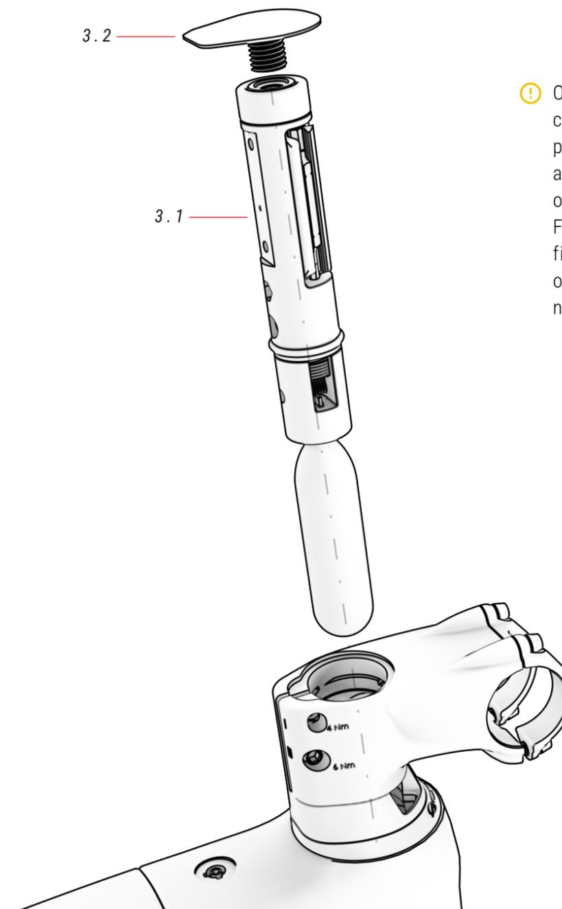
⚠ O capacete deve estar completamente vazio por dentro para montar a ferramenta FIT. Utilize o sistema de lavagem FIT fornecido para este fim e remova quaisquer obstáculos como a aranha no tubo superior.
