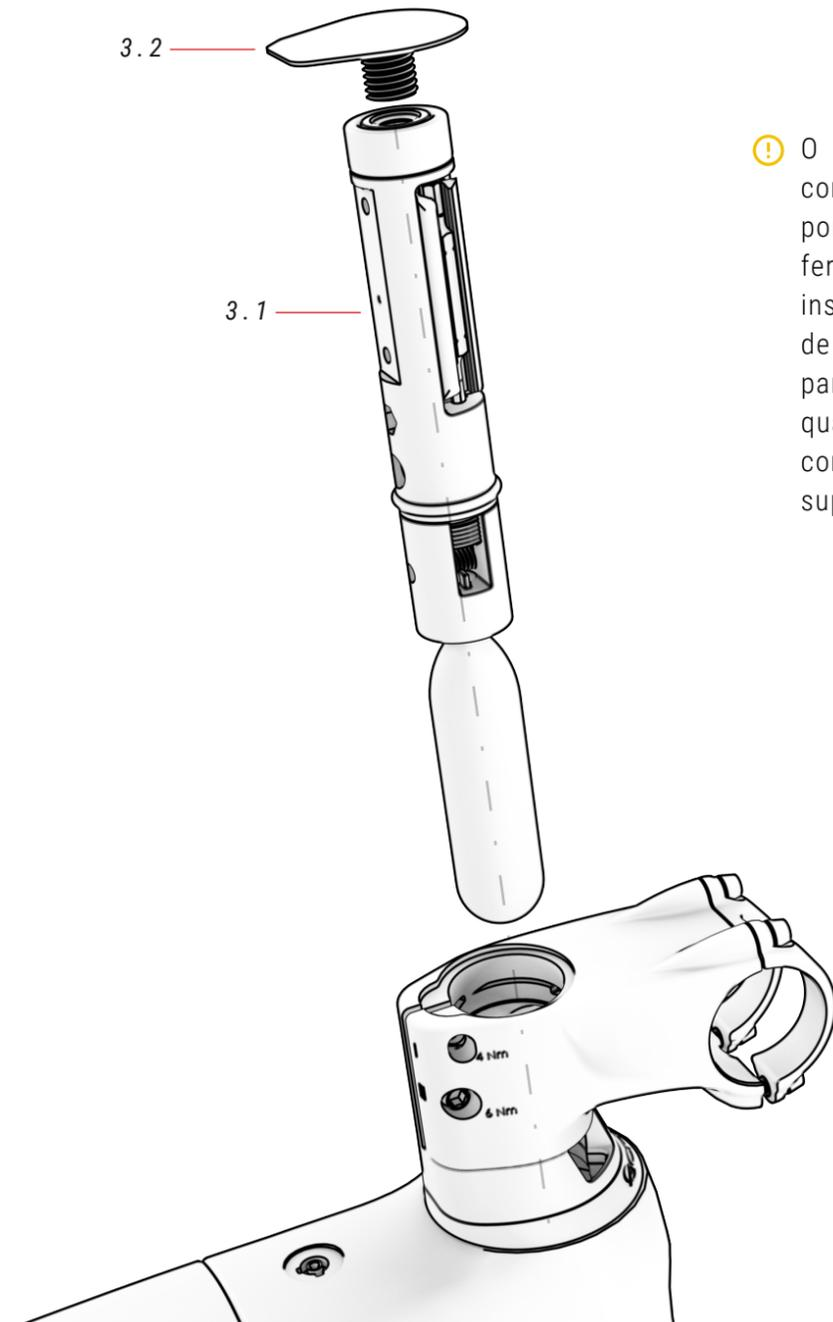
⚠ O auricular deve estar completamente vazio por dentro antes de a ferramenta FIT poder ser instalada. Utilize o sistema de lavagem FIT concebido para o efeito e remova quaisquer obstáculos como a aranha no tubo superior.
