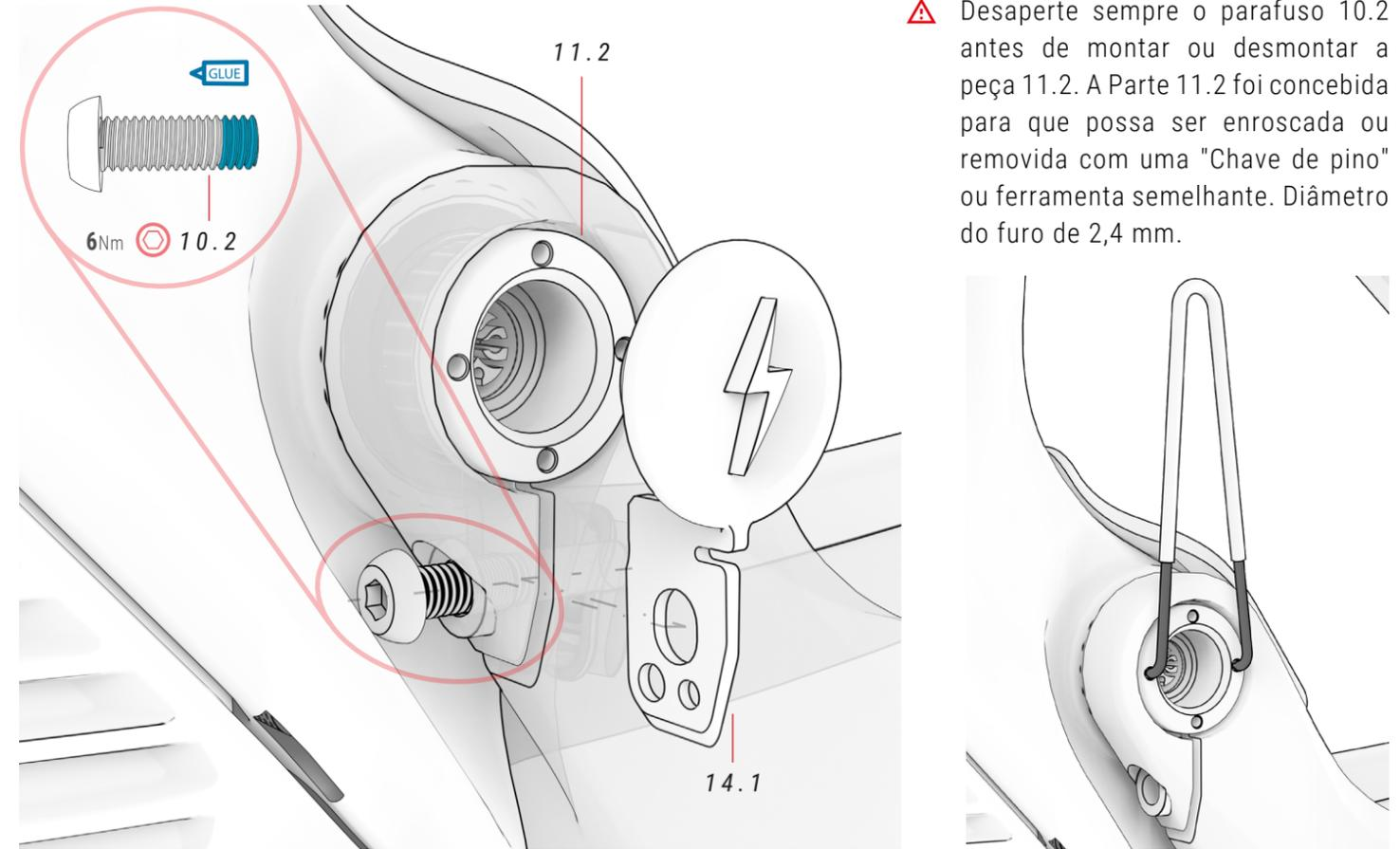
⚠ Desaperte sempre o parafuso 10.2 antes de montar ou desmontar a peça 11.2. A Parte 11.2 foi concebida para que possa ser enroscada ou removida com uma "Chave de pino" ou ferramenta semelhante. Diâmetro do furo de 2,4 mm.
