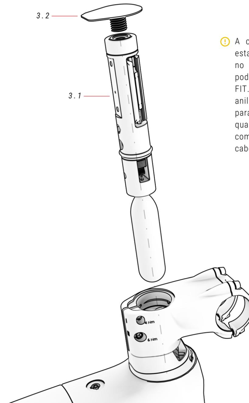
⚠ A caixa de direção deve estar completamente vazia no interior, antes de se poder colocar a ferramenta FIT. Utilize o sistema de anilhas FIT concebido para o efeito e remova quaisquer obstáculos, tais como a aranha no tubo da cabeça.
