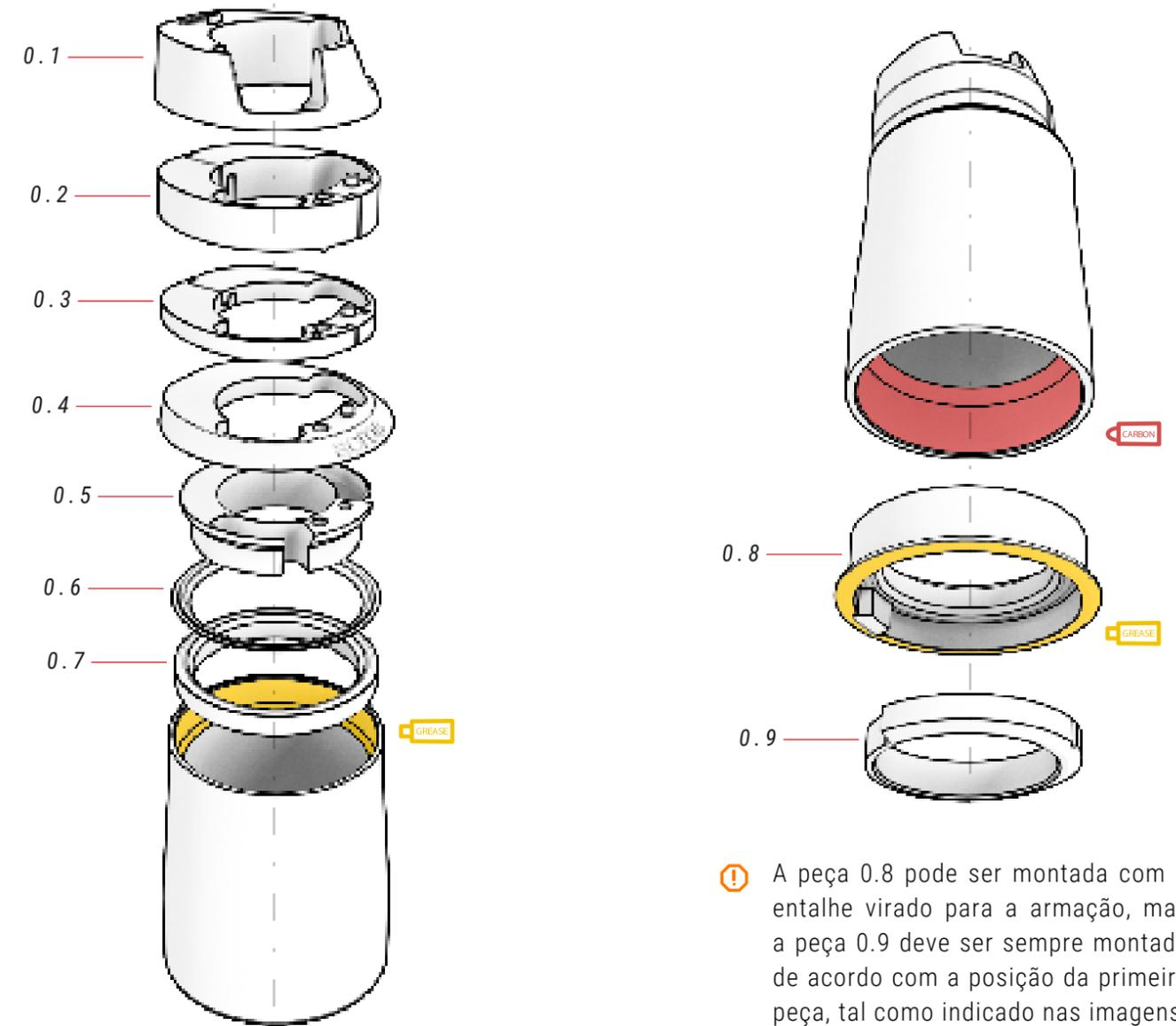
⚠ A peça 0.8 pode ser montada com o entalhe virado para a armação, mas a peça 0.9 deve ser sempre montada de acordo com a posição da primeira peça, tal como indicado nas imagens.
