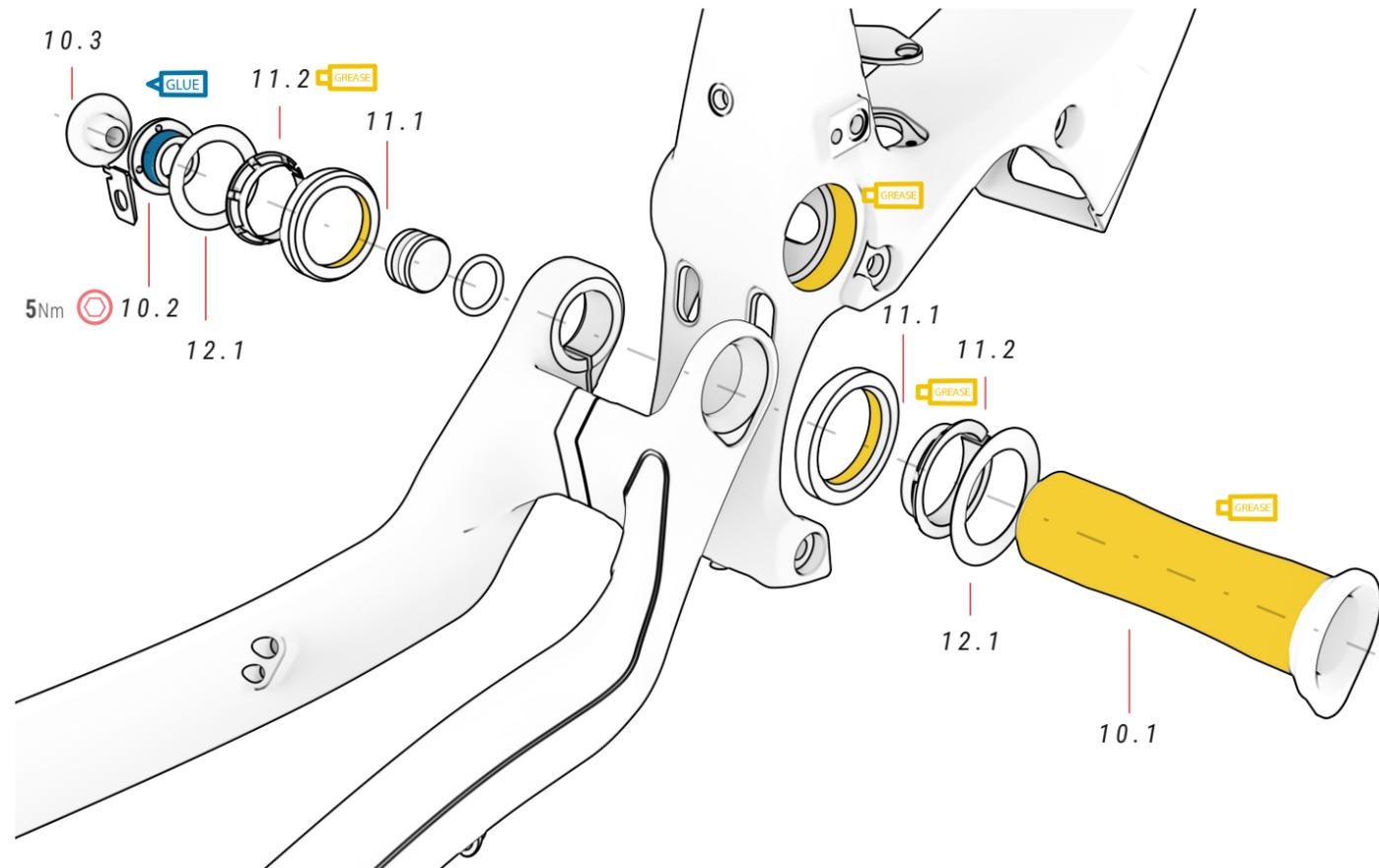
ⓘ A peça 10.2 não deve apertar-se mais de 5 Nm, pois a sua função é evitar folgas. A peça 16.2 fixa completamente a peça 10.2.
