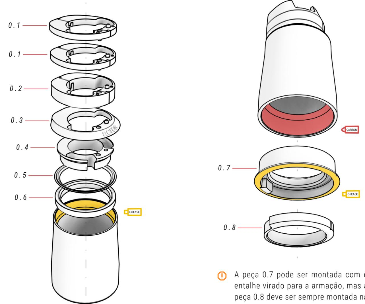
⚠ A peça 0.7 pode ser montada com o entalhe virado para a armação, mas a peça 0.8 deve ser sempre montada na primeira posição, como indicado nas imagens.
