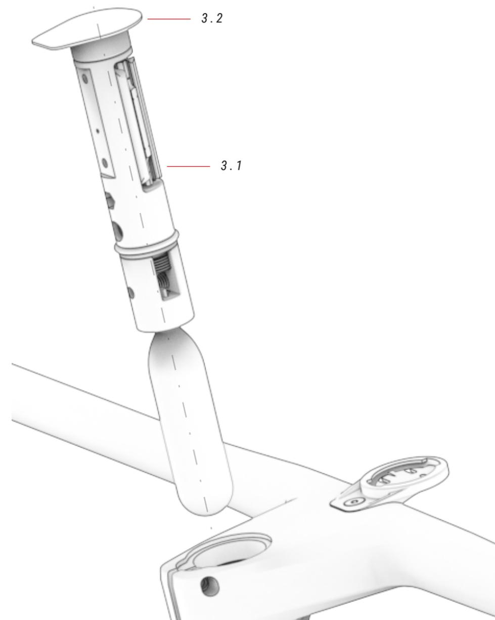
⚠ A caixa de direção deve estar completamente vazia no interior, antes de se poder colocar a ferramenta FIT. Utilizar o sistema de arruelas FIT concebido para o efeito e remover todos os obstáculos, tais como a aranha no tubo da cabeça.
