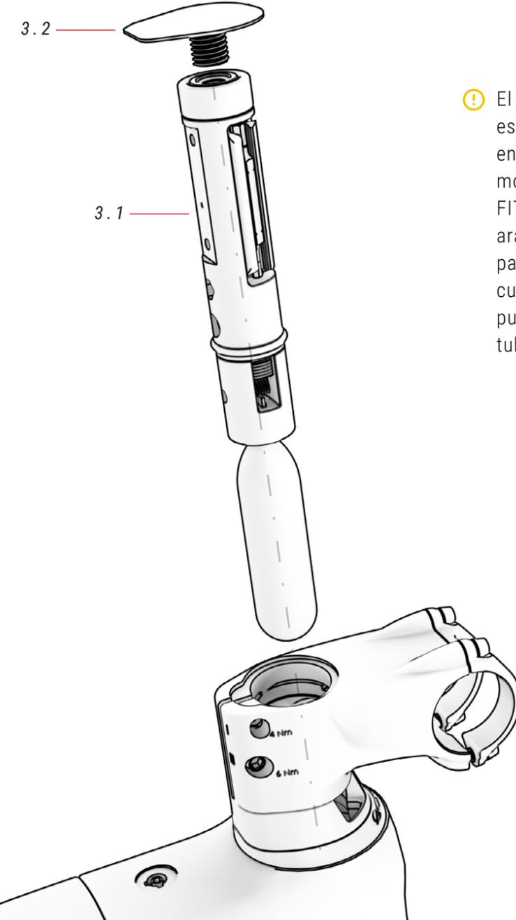
⚠ El juego de dirección debe estar completamente vacío en su interior para poder montar la herramienta FIT. Utiliza el sistema de arandelas FIT diseñado para este fin y retira cualquier obstáculo como pudiera ser la araña en el tubo de dirección.
