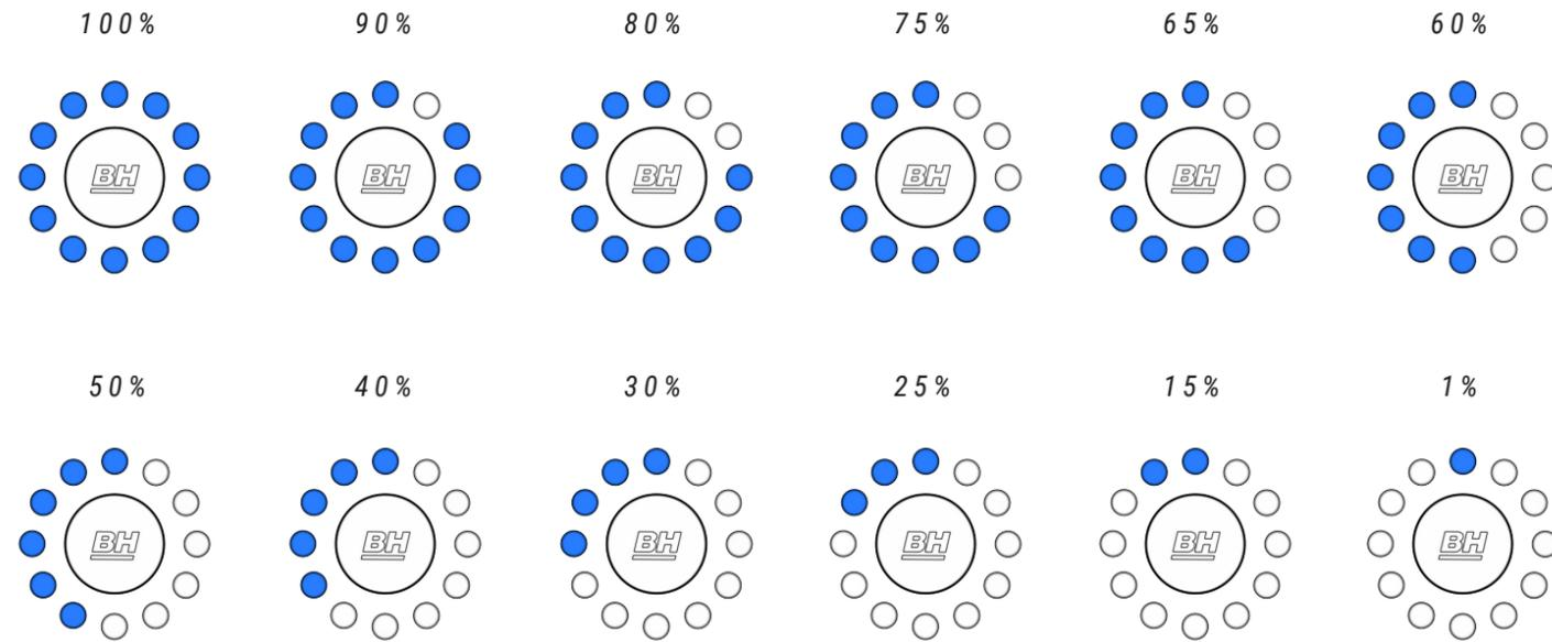
En los modelos equipados con el Core display el nivel de carga de la batería XPRO DD se indica mediante el anillo de leds. La capacidad de la batería XPRO DD se sumará a la capacidad de la batería interna de la bicicleta y el display mostrará la carga total del conjunto de la siguiente manera:
