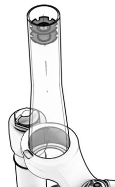
**⚠** Es recomendable utilizar un embotador para asegurar que la araña se inserta en el tubo de dirección perfectamente alineada.
