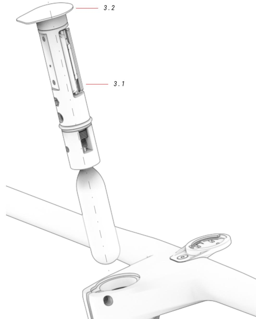
⚠ El juego de dirección debe estar completamente vacío en su interior para poder montar la herramienta FIT. Utiliza el sistema de arandelas FIT diseñado para este fin y retira cualquier obstáculo como pudiera ser la araña en el tubo de dirección.
