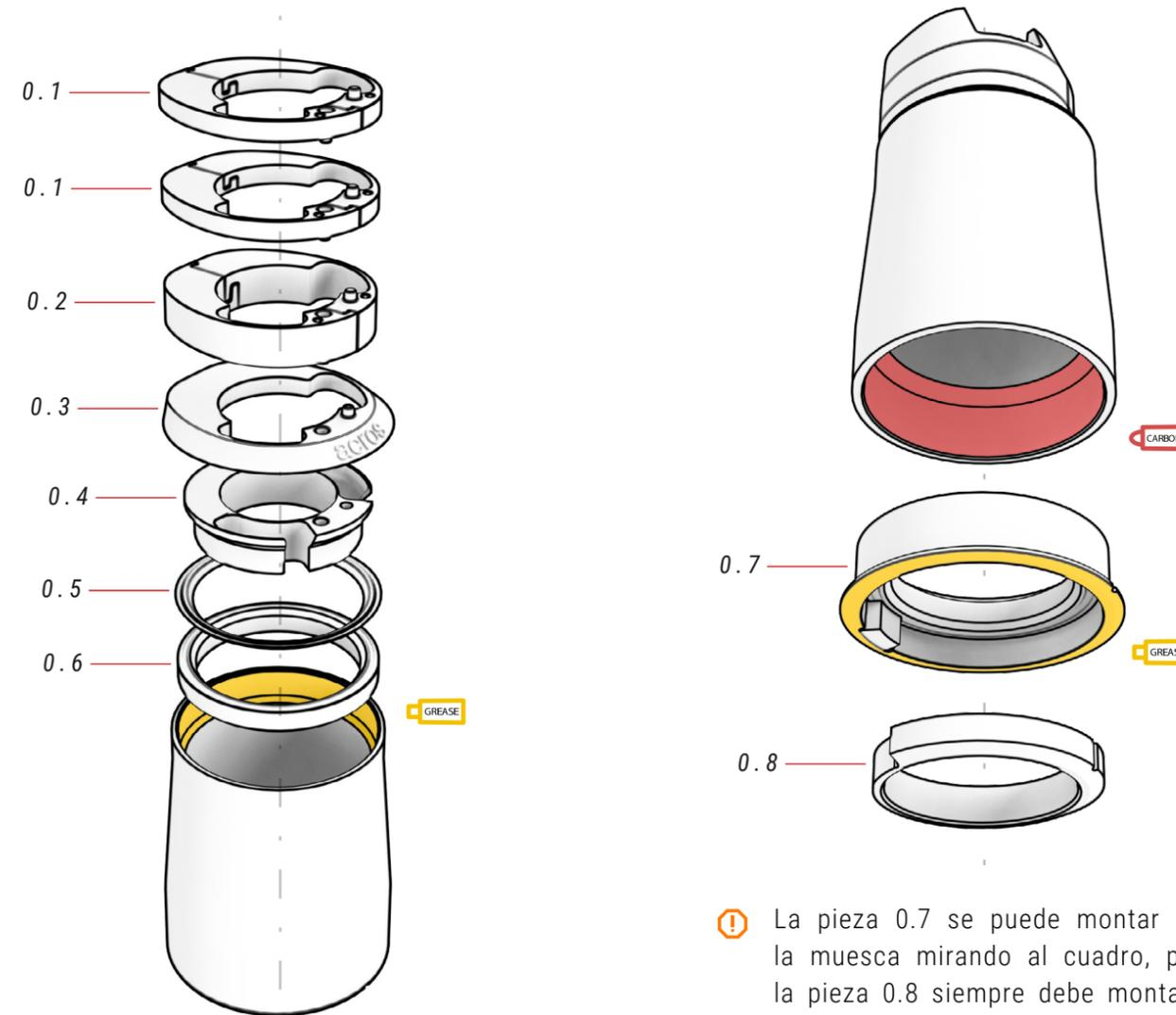
⚠ La pieza 0.7 se puede montar con la muesca mirando al cuadro, pero la pieza 0.8 siempre debe montarse acorde a la posición de la primera como se muestra en las imágenes.
